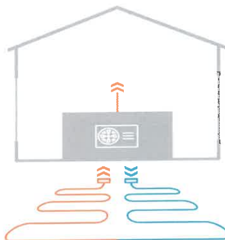
C - BODEM / WATER (HORIZONTAAL)
